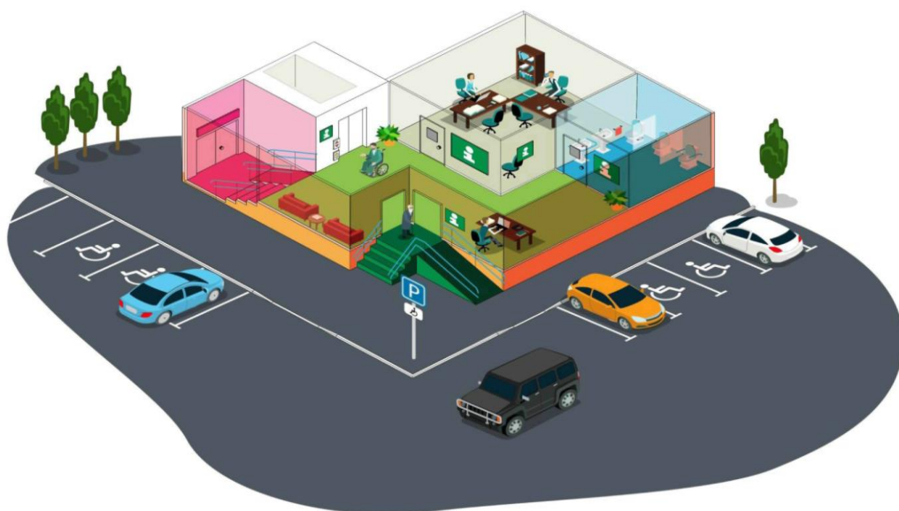
Рис. 3. Основные структурно-функциональные зоны и элементы зданий и сооружений, подлежащие адаптации для инвалидов
